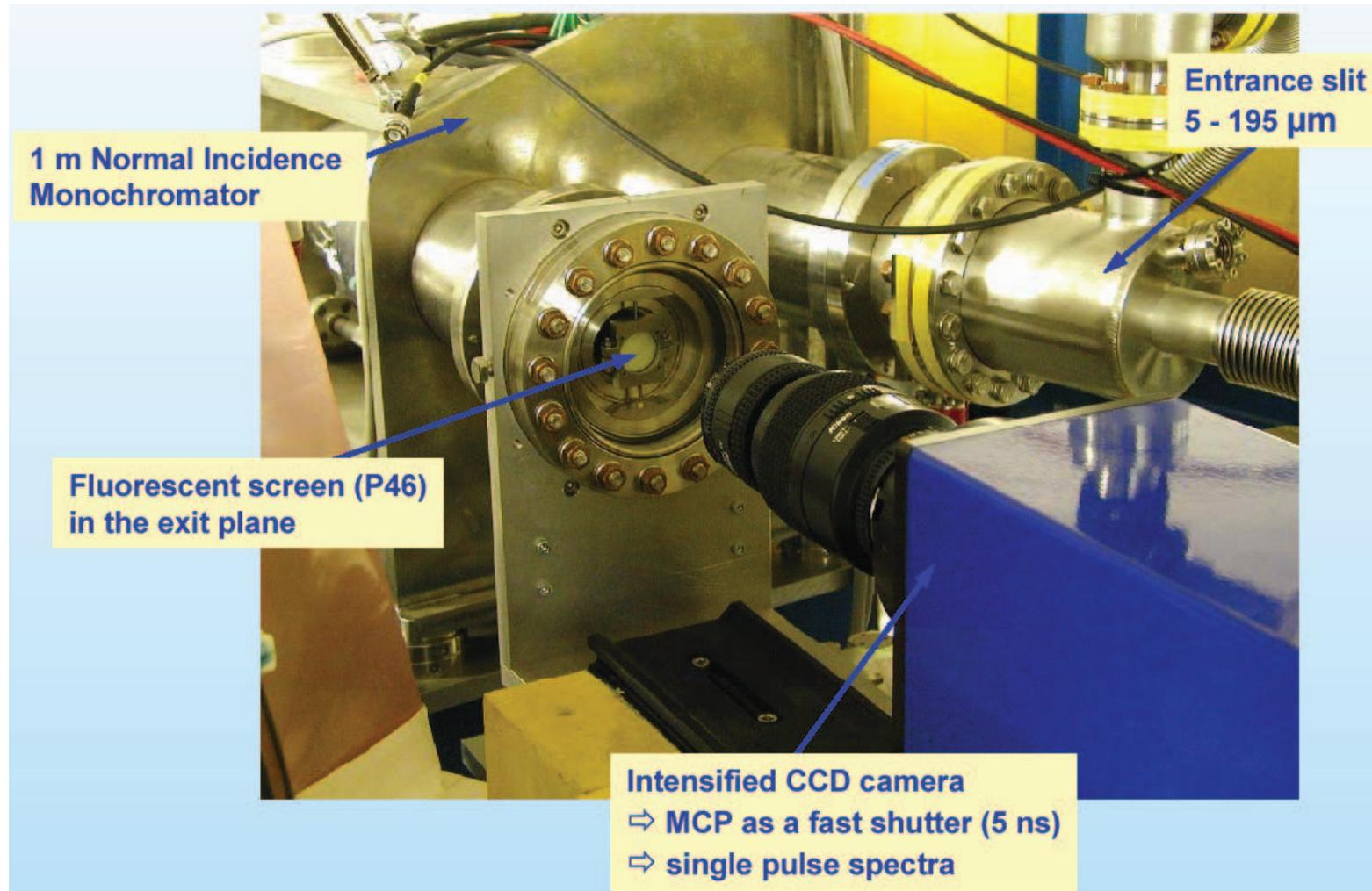
Aufbau zur Messung jedes einzelnen SASE Spektrums
