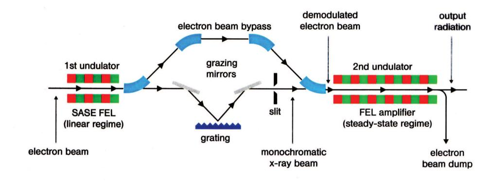
Lichtpuls des ersten SASE FEL muß im zweiten Undulator mit dem gleichen Elektronenbunch, der den Lichtpuls erzeugt hat überlagert werden.
