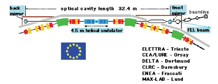
• Im Oszillatorbetrieb ist der UV Bereich bis  $\lambda = 190$  nm zugänglich.
