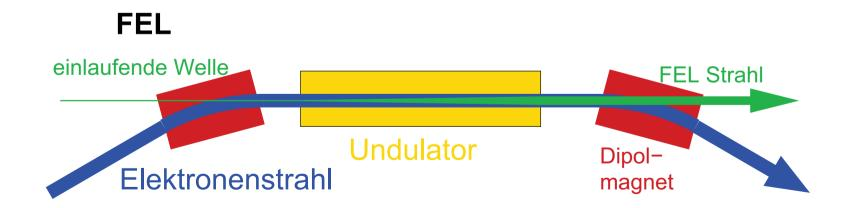
• Aus dem Elektronenstrahl muß Energie in das Laserfeld  $\vec{E}_{FFI}$ entlang des Weges s übertragen werden.
