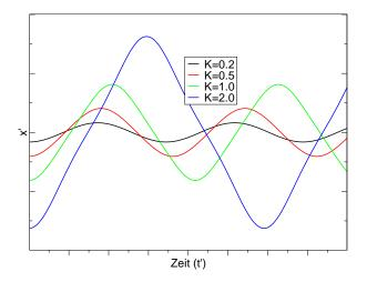
Früheres Ergebnis für die Geschwindigkeiten in einem planaren Undulator:
